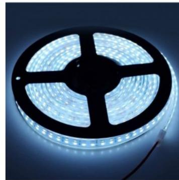
Ruban LED 24V-DC 18W/m monochrome IP67 (SMD2835 120LED/m) Rouleau de 5 mètres
