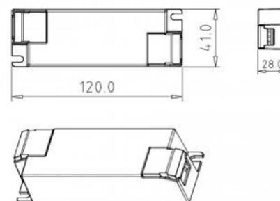
**Driver DALI DT6 monochrome dimmable 220-240V - Sortie 6-58V DC - 250-700mA - 25W**
