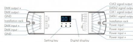
**Décodeur DMX512 vers SPI Pixel 5-24V DC - Contrôleur RF**
