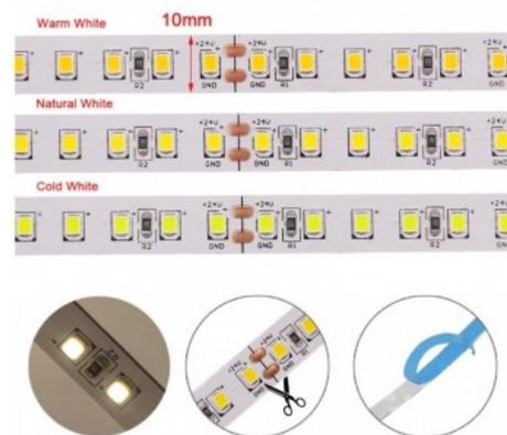
**Ruban LED 24V-DC - 9W/m - monochrome - 10mm - IP20 - Rouleau de 50 mètres - 60 LED/m - Sécable tous les 10 cm**
