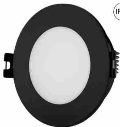
Collerette downlight étanche ronde pour ampoule GU10 / MR16 - Diffuseur opale - Coupe Ø 75-80 mm - IP54
